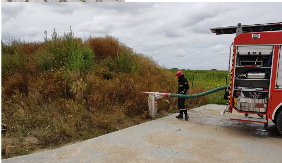
Kontrola możliwości poboru wody z zastępczego źródła wody
